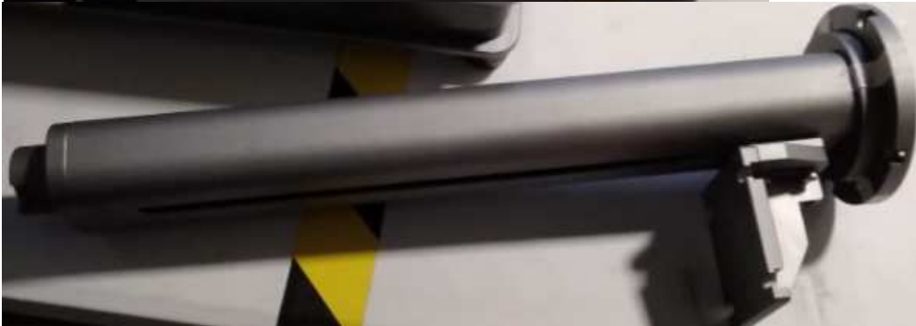
Identificamos los agujeros para la instalación del poste que realiza el movimiento en Z (arriba y abajo)
